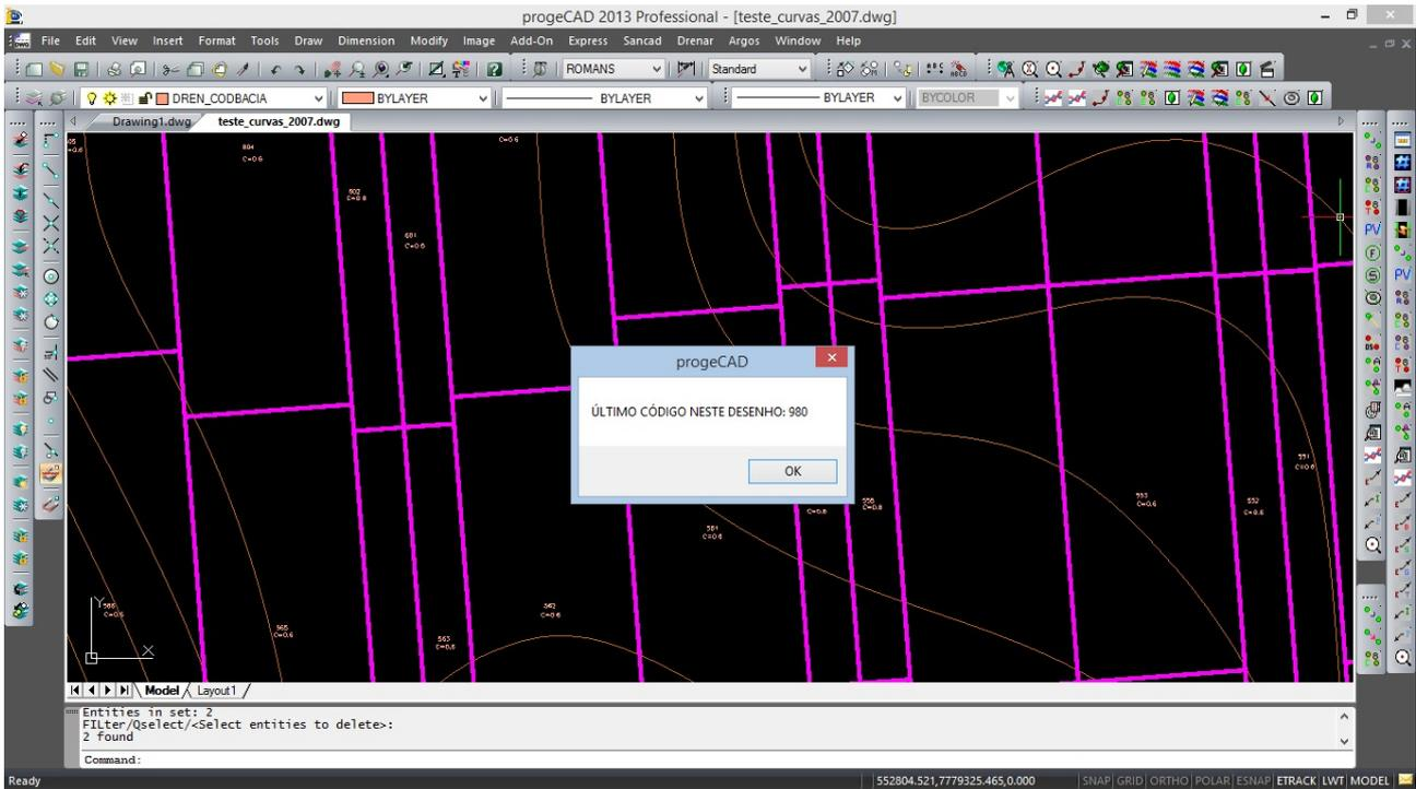
Em seguida, pede-se o clique na Área desejada e abre-se a caixa de diálogo com o código sequencial sugerido e o campo para digitação do valor do coeficiente “C” de run-off correspondente à Área. Este valor fica entre 0 e 1, como, por exemplo, C = 0,6.
