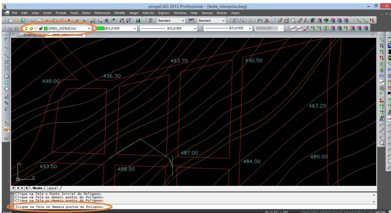
Não é necessário acionar o OSNAP ENDPOINT nem para fechamento do polígono, nem para justapor segmentos do polígono que está sendo desenhado com os vértices de outros já existentes, já que a rotina, percebendo o clique próximo aos pontos já existentes, gera automaticamente o ENDPOINT para cada vértice. E finaliza o lançamento da Área, conforme abaixo:
