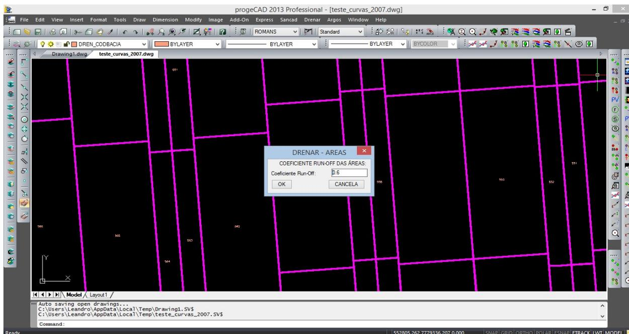
Basta confirmar e aguardar a conclusão da rotina. Deve-se observar que ao iniciar a sua execução, a rotina faz uma verificação geral em todo o DWG para detectar a existência de polylines abertas indevidamente na camada de definição das Áreas. Detectando, a rotina é interrompida e gera um zoom na região e um destaque na Área a ser corrigida. Somente após passar sem erros nessa verificação é que a rotina continua.
