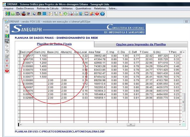
Toda a parte gráfica subsequente é compatível com essa escolha, sendo apresentada em planta e em perfil conforme a seção adotada, ou seja, se circular, apresenta-se como “DN”, se retangular, apresenta-se como “BASExALTURA”.
