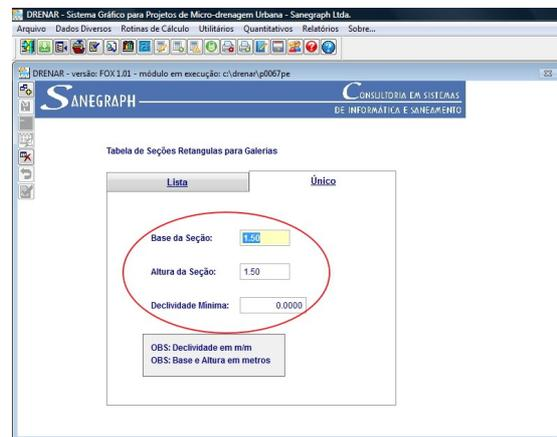
Uma vez o Operador tendo as seções cadastradas, poderá então passar a utilizá-las na rotina de dimensionamento da rede/galerias. Optamos por deixar como default na rotina de cálculo as seções circulares tradicionais e fazer aparecer a seção retangular apenas nos cálculos na forma que chamamos de “manual” (a forma “manual” ou “automática” é definida no menu “Utilitários / Configurações” ou simplesmente na própria rotina de dimensionamento da rede).
