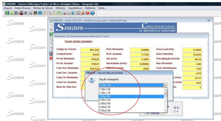
Ao confirmar o uso da seção e sendo esta compatível com as condições de escoamento, suas dimensões BASE e ALTURA são salvas na planilha, ao mesmo tempo que é limpo o campo do diâmetro circular. E vice-versa, optando o Projetista pela seção circular e definindo um diâmetro, os campos da BASE e da ALTURA são automaticamente limpos.
