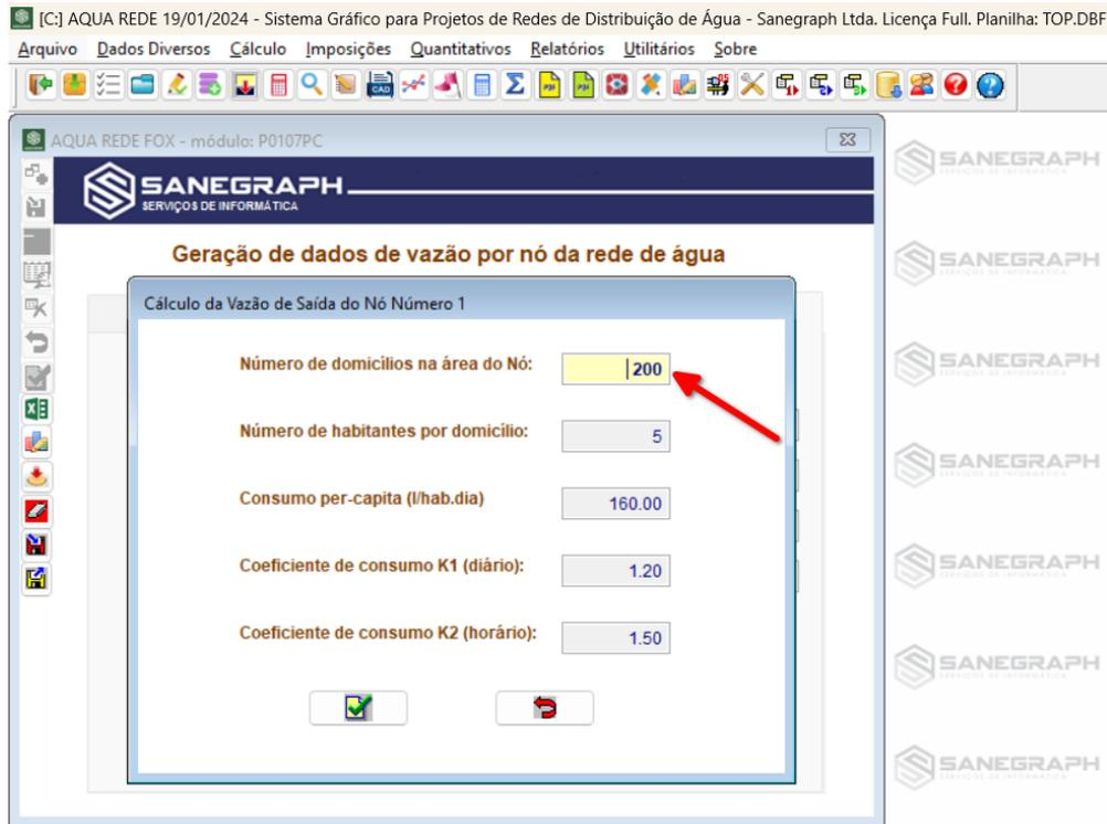
Ao conformar os dados, o programa irá calcular a vazão e preencher automaticamente o campo da vazão de saída do nó, conforme imagem:
