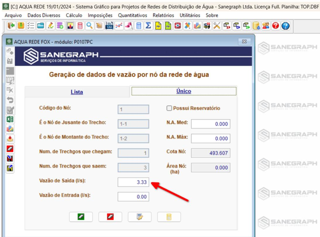
E então é repetir este procedimento para todos os nós que compõem o projeto, de forma a finalizar o carregamento das vazões. Em seguida, deve-se calcular a vazão dos trechos (aproximação inicial) e disparar a rotina de dimensionamento da rede.
